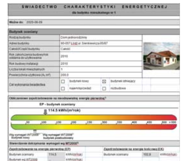
↑ Rys. 8. Raport świadectwa charakterystyki energetycznej budynku
